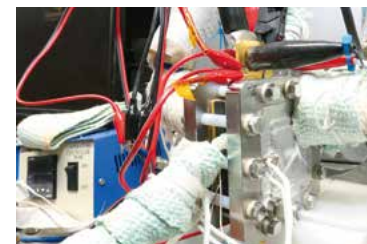
燃料電池の発電実験。膜や電極材料の性能を測定中。
