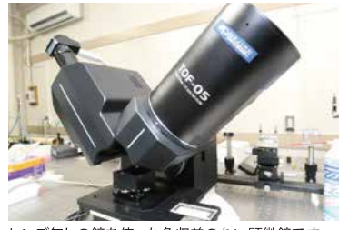
レンズ無しの鏡を使った色収差のない顕微鏡です。
