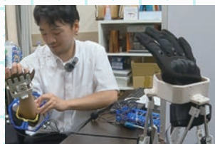
人の動きを真似るウェアラブルロボット マスターズレイブロボット。
